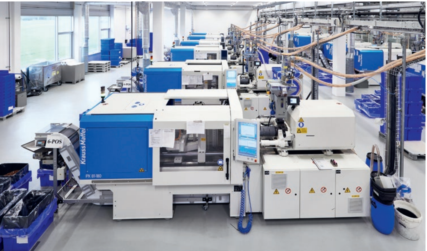
Spritzgussanlagen der Michel Werkzeugbau AG für die Herstellung der Wicovalve-Komponenten.
